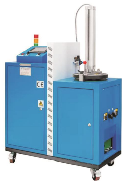
HY-M5 溶胶机 HY-M5 PUR melter
